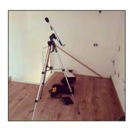
Apparecchio fonometrico per rilievo intensità e frequenza del suono
